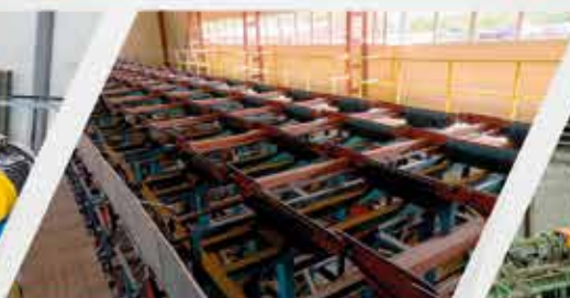
Линия сортировки пиломатериала
